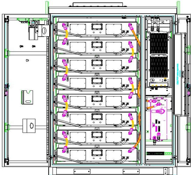
Figura 2-6 Diagrama de cableado del cable de alimentación
